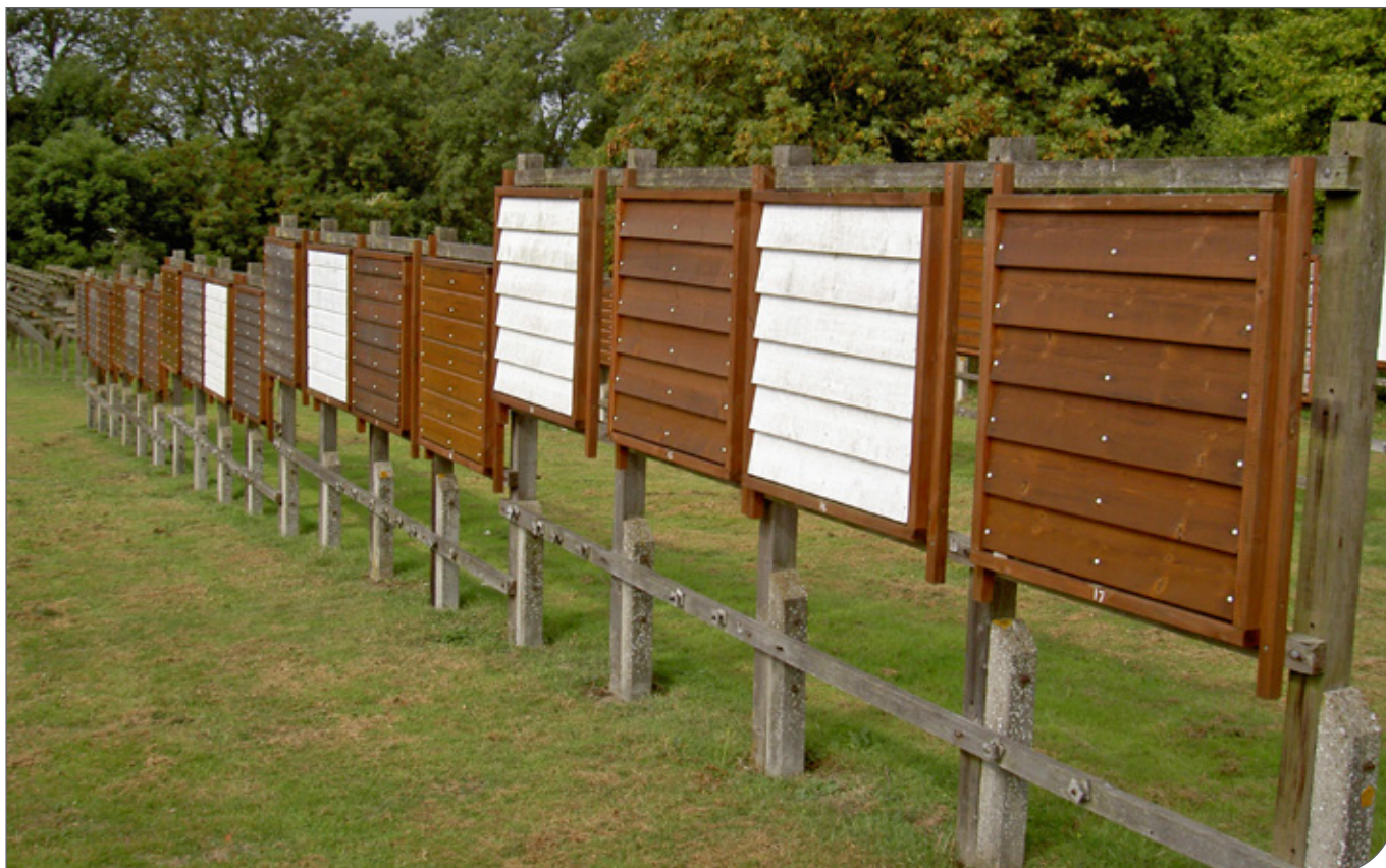
Bild 19. ThermoWood® fälttest i Storbritannien (BRE).
